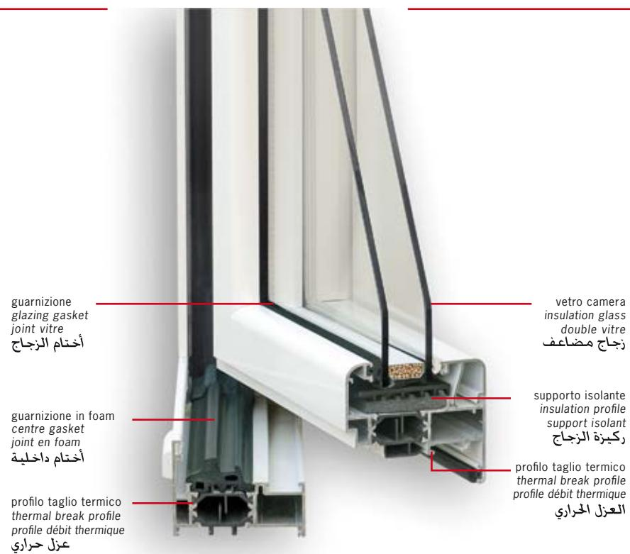
■  $U_w = 1,20 \text{ w/m}^2\text{k}$     $U_g = 0,60 \text{ w/m}^2\text{k}$     $\psi_i = 0,11 \text{ w/mk}$
