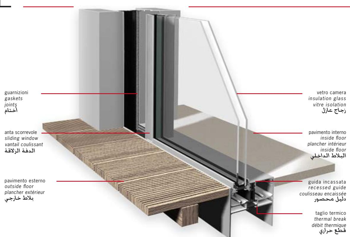
■  $U_w = 0,91 \text{ W/m}^2\text{k}$     $U_g = 0,50 \text{ W/m}^2\text{k}$     $\psi_i = 0,04 \text{ W/mk}$
