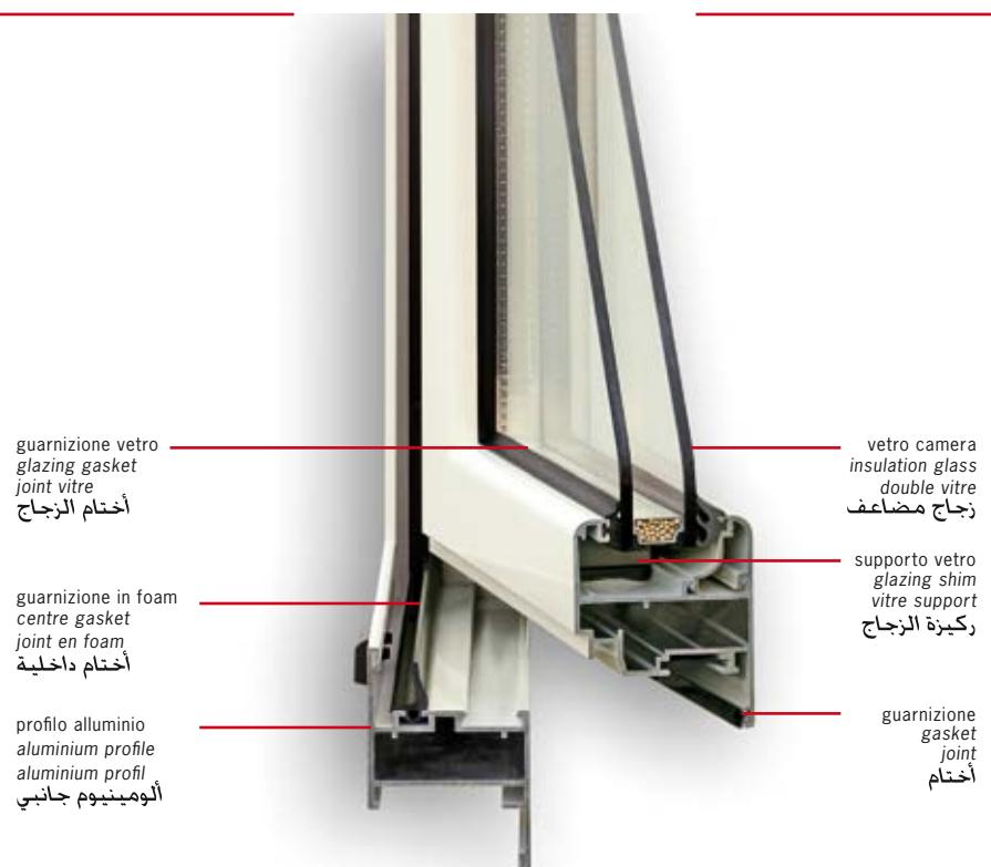
■  $U_w = 3,63 \text{ W/m}^2\text{K}$        $U_g = 2,80 \text{ W/m}^2\text{K}$        $\psi_i = 0,11 \text{ W/mK}$       Finestra 1 Anta mm. 1230 x 1480
